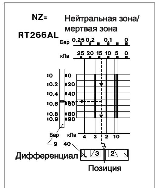
**Техническое описание Реле разности давлений типа RT**
