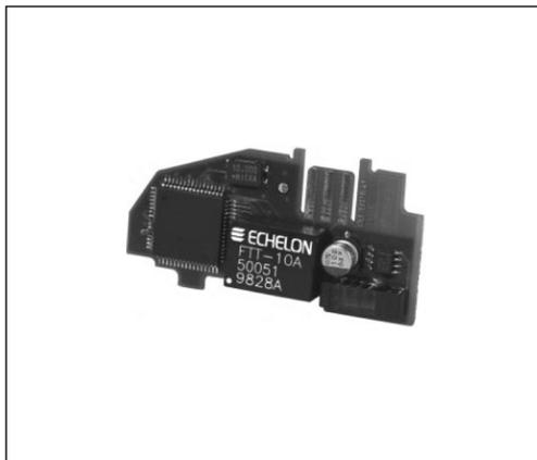
Модуль связи ECA 82 обеспечивает подключение регуляторов ECL Comfort 300, 301 к сети LON по интерфейсу FTT-10 для мониторинга и управления со стороны других узлов сети. При использовании ECA 82 применение других коммуникационных модулей невозможно. ECA 82 реализует стандартный протокол LonWorks и переменные в соответствии со стандартным перечнем SNVT LON.
