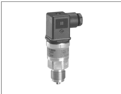
Преобразователи давления предназначены для измерения давлений жидкостей и газов в промышленности. Корпус датчика изготовлен из кислотостойкой нержавеющей стали. Точность обеспечивается лазерной калибровкой, встроенной температурной компенсацией и помехозащищенностью в соответствии с нормами электромагнитной совместимости EU EMC.
