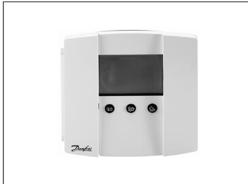
Комнатная панель ECA 60 предназначена для регулирования и коррекции температуры в помещении при работе совместно с регуляторами ECL Comfort 100, 200 и 300; подключается к электронному регулятору ECL Comfort с помощью двухпроводной шины и запитывается от электронного регулятора.
